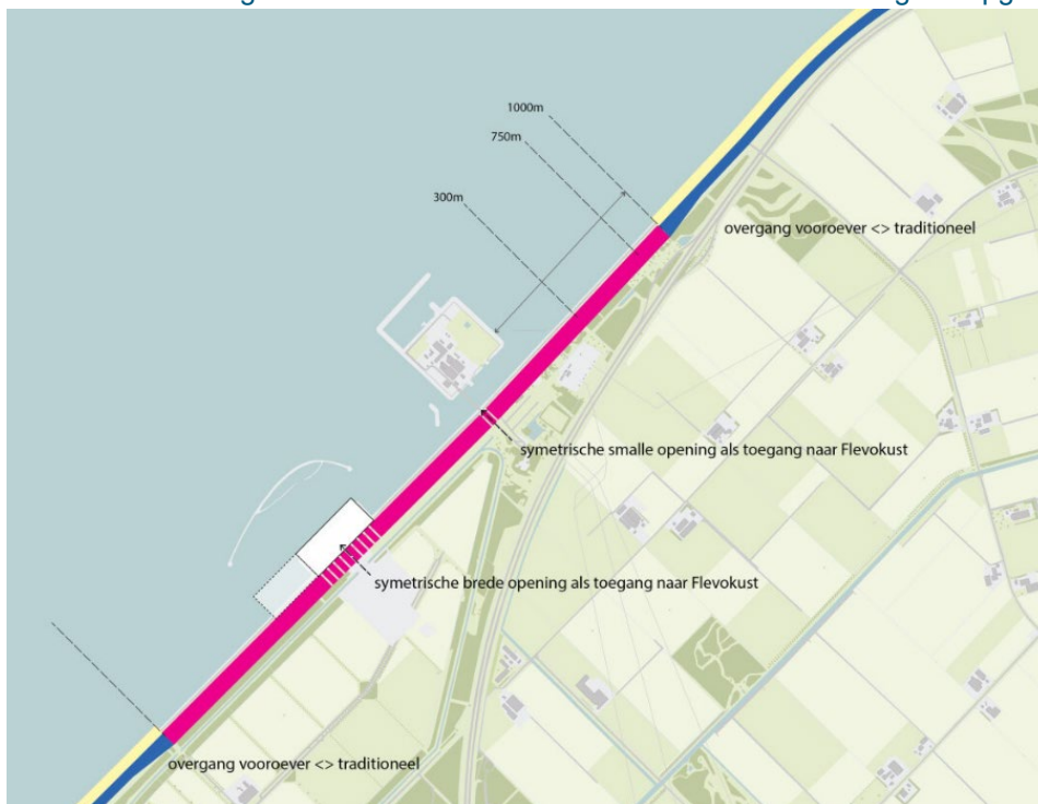
Figuur 3-4: variant A (blauw huidige dijk, geel vooroever en rood traditionele dijkversterking)
