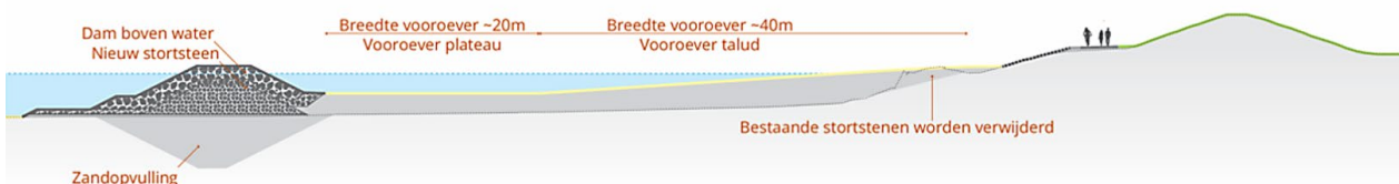
Figuur 3-16: Variant C voor Meerdijk-Noord – Dam boven water met oplopend voorland
