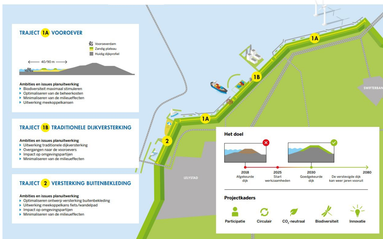
Figuur 1-3: Schematische weergave van de ontwerp-opgave van het project Versterking IJsselmeerdijk.
