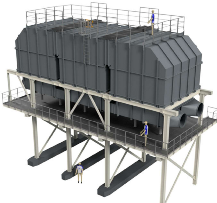
Figuur 1 : E-RTO op een verhoogde constructie
