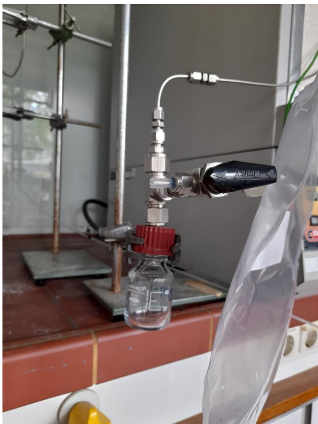
Figuur 3: opvang van gas in Tedlarbag en vloeistof in een glazen monsterfles
