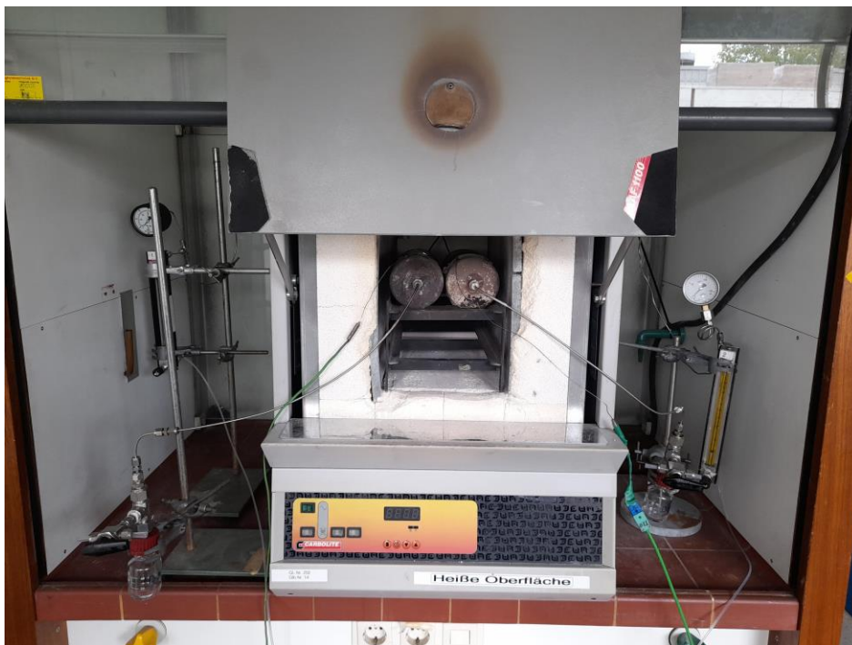
Figuur 2: overzicht moffeloven en opstelling
