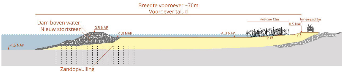
Figuur 2–4 Profiel van de vooroever zuid referentieontwerp (Voorkeursvariant).
