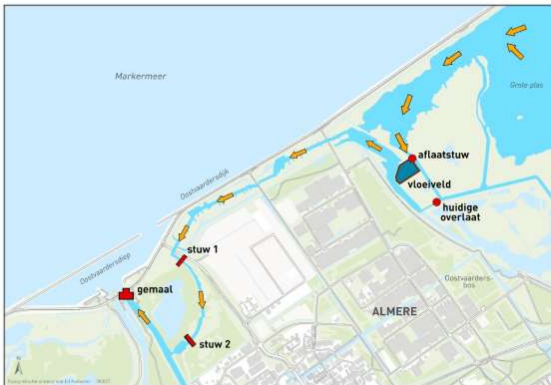
Figuur 5: aflaten water naar Markermeer en te treffen en aanwezige voorzieningen
