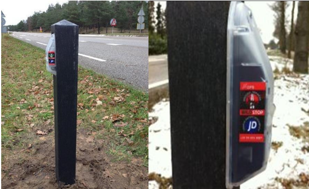
Figuur 8. De palen van een wildwaarschuwingssysteem
